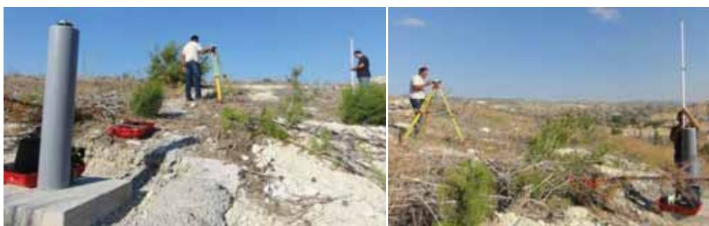
Εικόνα 18 Μέτρηση ύψους Οργάνου στο βάθρο
