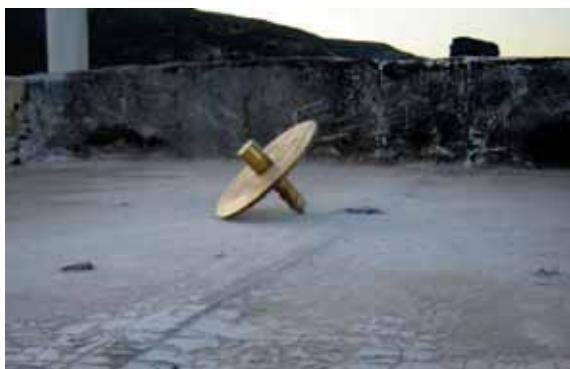
**Εικόνα 13 Βάση στερέωσης τρικοχλίων από ορείχαλκο που χρησιμοποιήθηκε στο φράγμα του Κούρη**
