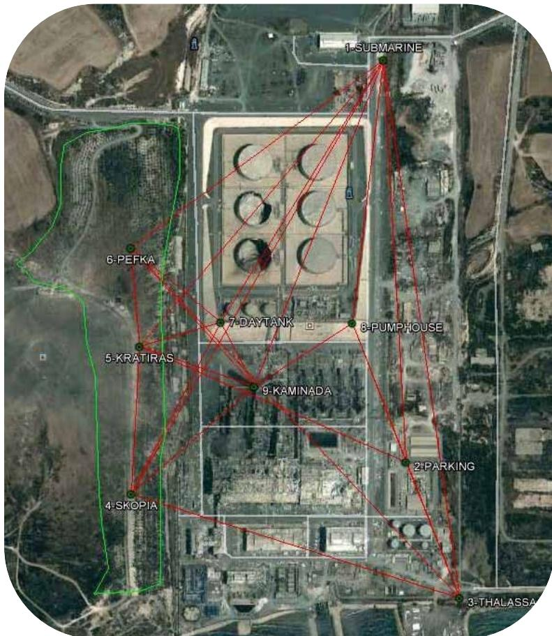
**Εικόνα 4 Μόνιμα σημεία τρισδιάστατου δικτύου**
